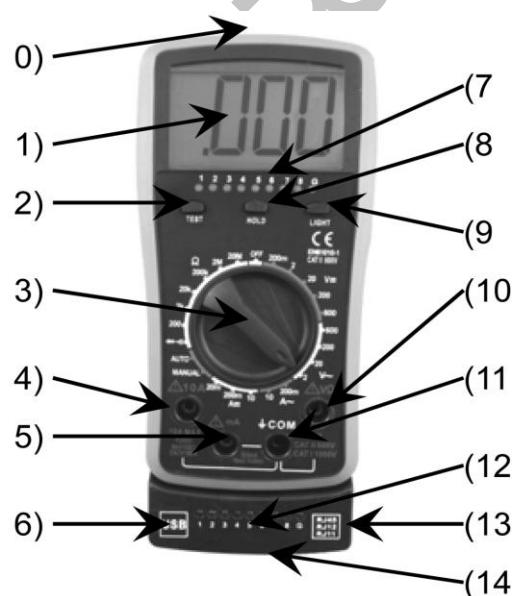
0) RJ45 (RJ11, RJ12), USB-разъем
