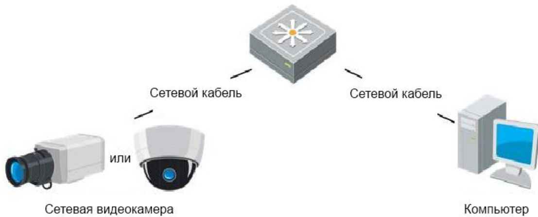
Рисунок 2-2 Подключение через коммутатор или роутер
