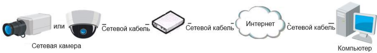
Рисунок 2-6 Доступ к видеокamере с динамическим IP адресом
