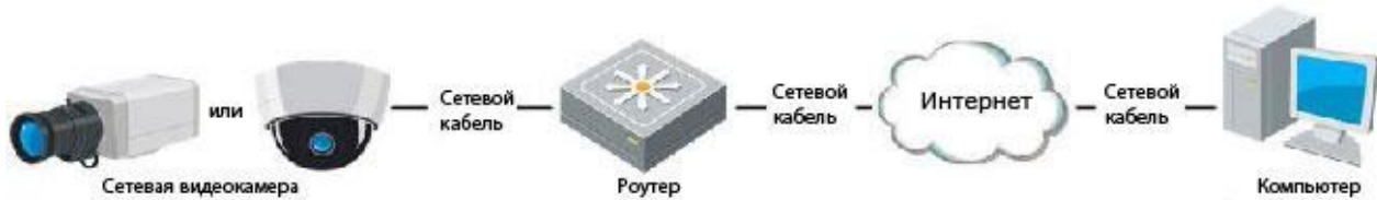
Рисунок 2-4 Доступ к видеокамере через роутер со статическим IP адресом
